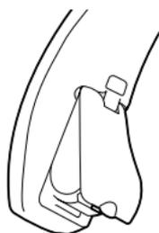
Abra el compartimento de pila para apagar el dispositivo.
