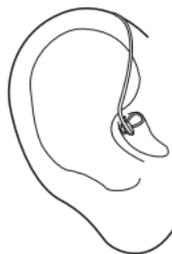
El aro del anclaje tiene el tamaño correcto cuando soporta bien la ubicación del adaptador de oído en el canal auditivo y cuando el adaptador de oído está bien asegurado en el oído.
