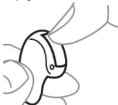
Fermez le couvercle du logement de la pile. Si celui-ci ne se ferme pas facilement, alors la pile n'est pas placée correctement.
