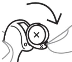
Utilisez l'ergot pour ouvrir délicatement le couvercle du logement de la pile en le faisant basculer, puis retirez la pile usée. Placez la pile neuve dans le logement de la pile en veillant à ce que le signe « + » soit orienté dans le même sens que le signe « - » sur le couvercle du logement de la pile, comme indiqué sur l'illustration.
