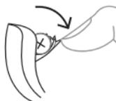
Utilizzare l'intaglio per aprire delicatamente lo sportello della batteria e rimuovere la vecchia batteria.
