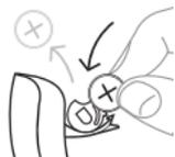
Ora inserire la nuova batteria nel vano batteria, come mostrato. Chiudere il vano batteria. Se non si chiude facilmente, la batteria non è correttamente collocata. Se non si utilizza l'apparecchio acustico per alcuni giorni, rimuovere la batteria.
