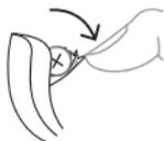
Um das Hörsystem auszuschalten, ziehen Sie den Batteriefachdeckel nach unten.
