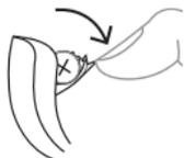
Öffnen Sie das Batteriefach.
