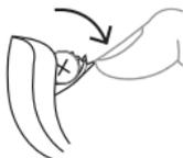
Öffnen Sie mit dem Nagelgriff vorsichtig das Batteriefach und entnehmen Sie die alte Batterie.
