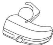
Legen Sie jetzt den Akku mit der goldenen Seite nach oben in das Batteriefach, und schließen Sie dieses.
