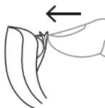
Um das Hörsystem einzuschalten, schließen Sie das Batteriefach. Das Hörsystem bestätigt durch ein akustisches Signal, dass es eingeschaltet ist, sofern Ihr Hörgeräte-Akustiker diese Funktion nicht deaktiviert hat.
